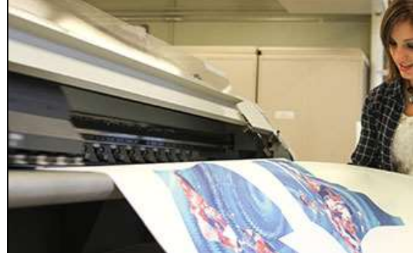
صورة رقم (21) طباعة التصميم على آلة النفث الحبرى صورة رقم (22) شكل التصميم المطبوع على القماش قبل اجراء عملية القص
