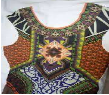
صورة رقم (21) طباعة التصميم على آلة النفث الحبرى صورة رقم (22) شكل التصميم المطبوع على القماش قبل اجراء عملية القص
